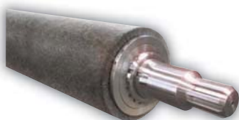
Esimerkki valssityypistä B, joka on pinnoitettu harjalla.
