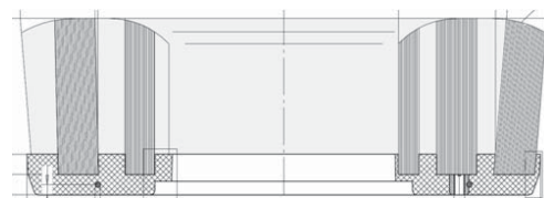
Harjan muoto voidaan myös profiloida sopimaan vanteen profiiliin.
