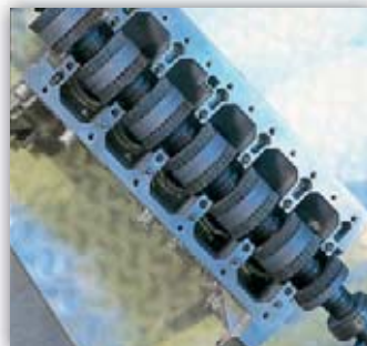
Tasoharjat soveltuvat esimerkiksi moottorilohkon purseidenpoistoon.
